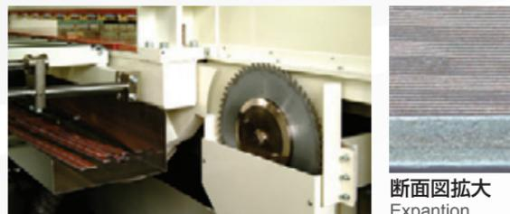
集塵カバー部と切断走行部は広い空間を有し、清掃管理が簡単です。又、チャック側の小さな端材は、チャック側の収納トレイ落とす構造で、端材が刃口に落ちるトラブル発生をなくしました。
