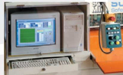
Windowsパソコンからグラフィカルな簡単操作・無尽蔵なデータの保存が出来ます。縦横切断が、自動運転中に押しボタンスイッチで切り替えられ、プログラムを変更しないで連続した縦横切断が行えます。
